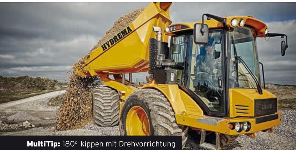
**MultiTip:** 180° kippen mit Drehvorrichtung
